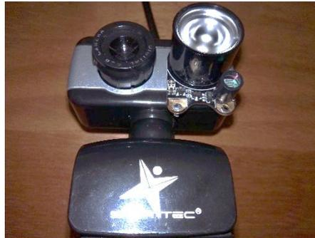
*Ilustración 16 Cámara con sensor infrarrojo*
