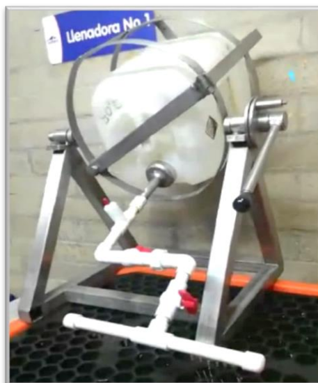
Ilustración 4. Máquina para el llenado de ácido de baterías Auteco SAS.
