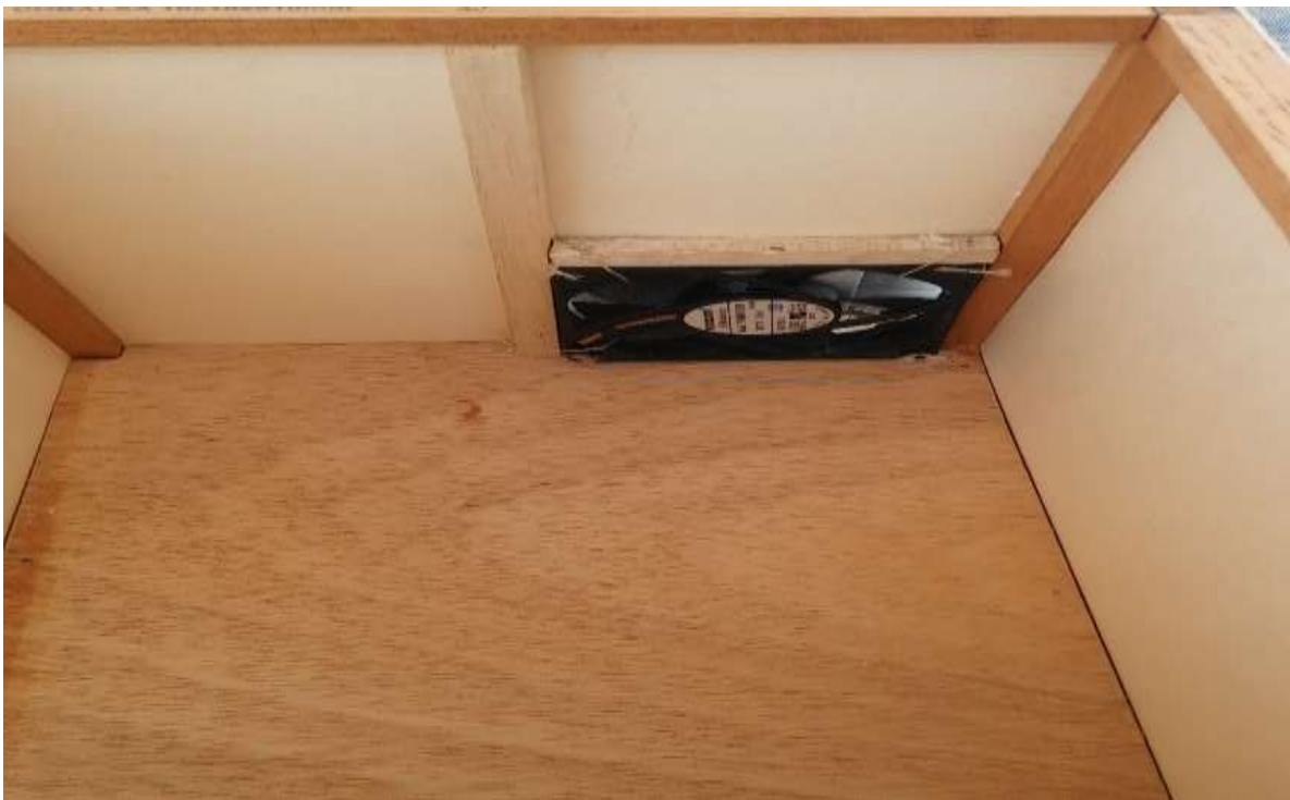
Ilustración 25. Instalación de sistema de refrigeración interna.
