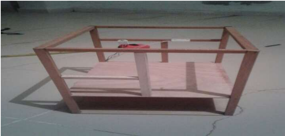
Ilustración 24. Estructura de maqueta con sensores.
