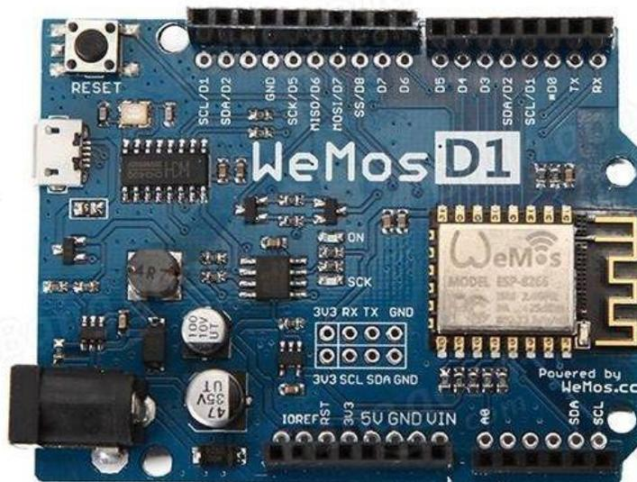
Figure 3. Placa Arduino Wemos
