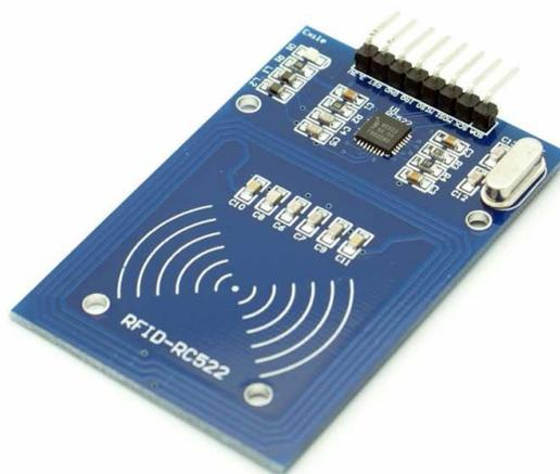
*Figure 2. Módulo RFID*
