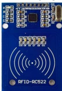
Figure 6. Módulo RFID de Arduino
