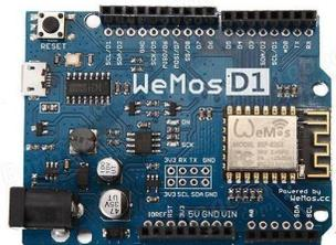
Figure 5. Placa Arduino Wemos D1
