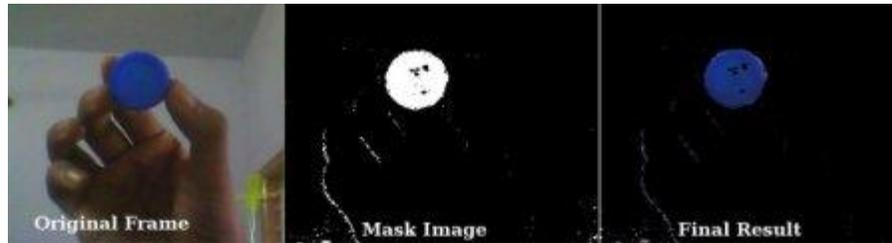
**Ilustración 8** Detección del color azul mediante openCV. (tomado de: [https://docs.opencv.org/3.0-beta/doc/py\\_tutorials/py\\_imgproc/py\\_colorspaces/py\\_colorspaces.html](https://docs.opencv.org/3.0-beta/doc/py_tutorials/py_imgproc/py_colorspaces/py_colorspaces.html))
