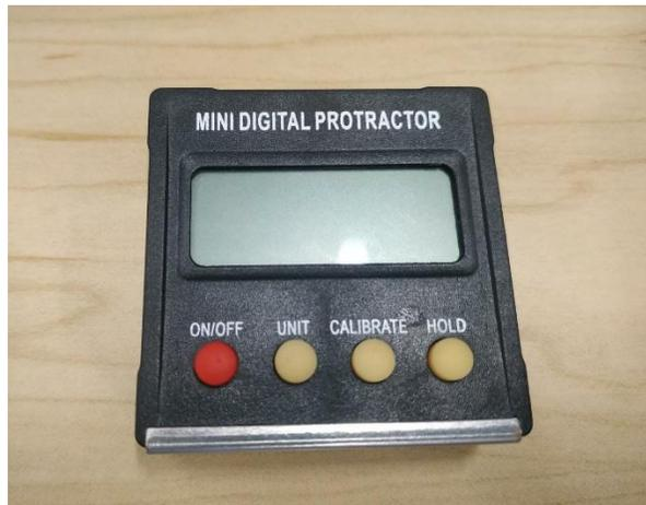
*Ilustración 26* Mini inclinómetro digital utilizado para medir los ángulos.
