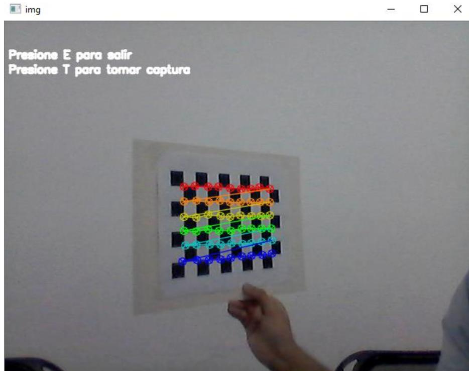
*Ilustración 38* frame de calibración de cámara.
