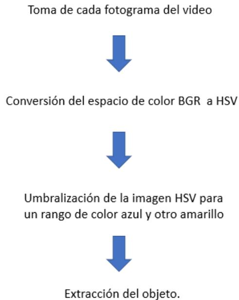
*Ilustración 7 Metodología para extracción de un objeto por color en una imagen. (imagen propia)*
