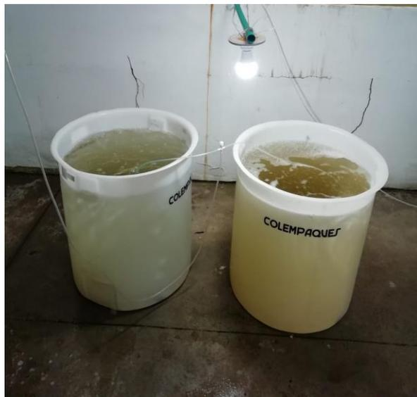
*Figura 2.* Tanques con 110L de agua de mar empleados en el montaje del pre-ensayo.
