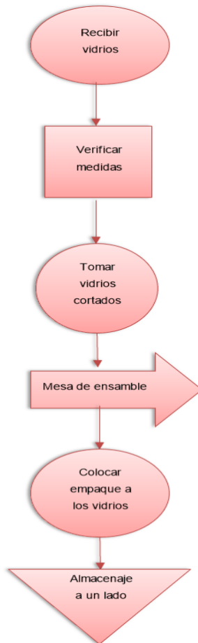
Figura 26. Diagrama de flujo de empaqueo de hojas.
