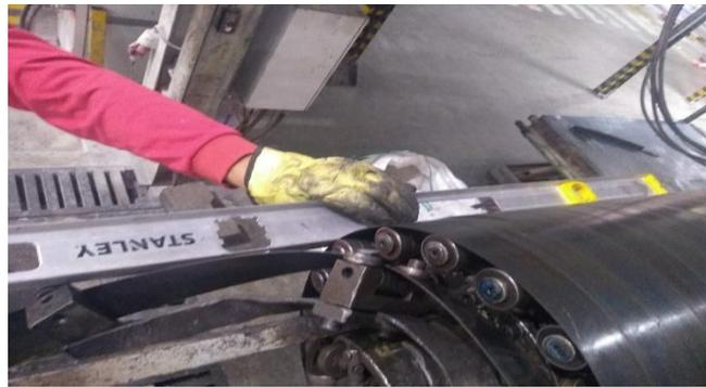
Al igual se hace con el cabezal, logrando una medida por debajo del plato 7 para evitar que el tubo saque el fleje en este punto.
