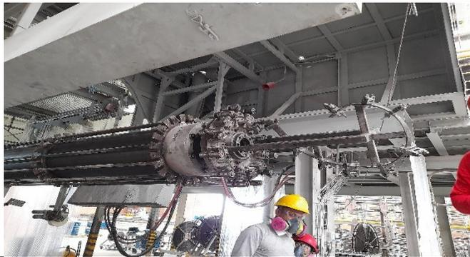
Calibrar el camplate: Se realiza la calibración del camplate luego de que los operarios monten la primera viga, para verificar el empuje de los pushers, los cuales son los elementos que empujan el fleje cuando está girando el mandril.
