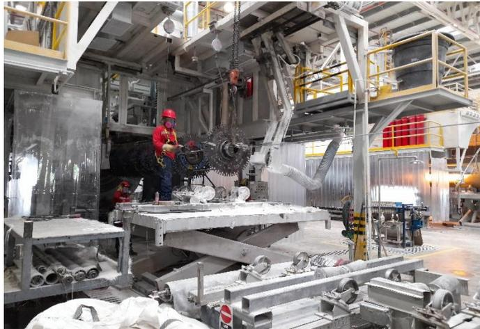
Luego de que se instale los platos inmediatamente se coloca la campana para asegurar el montaje en el eje.
