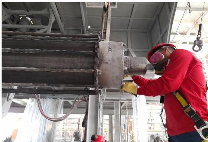
Colocar el cabezal: Se coloca el cabezal de la referencia a utilizar y se instala en el eje luego de haber colocado el conjunto de platos y la campana.
