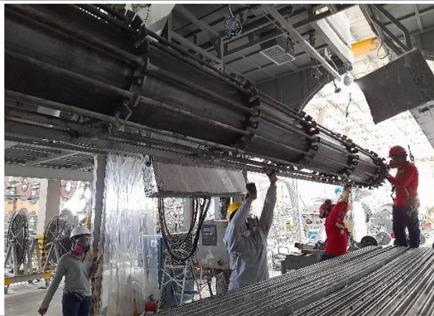
Colocar el cacho: El cacho se coloca para darle guía a los pushers en el camplate, esto es colocado por 2 operarios
