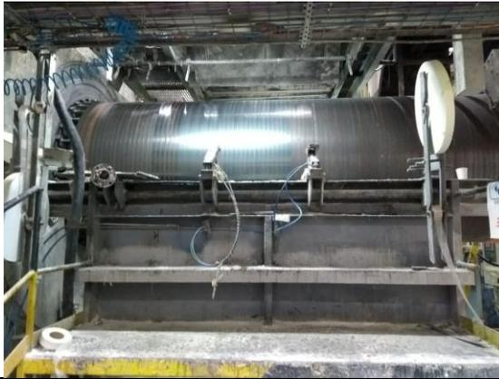
Medir mandril: Esta actividad se hace con el fin de verificar las medidas que debe tener el mandril, con ayuda de un circo metro, se mide el diámetro de cada uno de los platos, identificándolos. previamente en el mandril para así asegurar que tengan la medida correspondiente.
