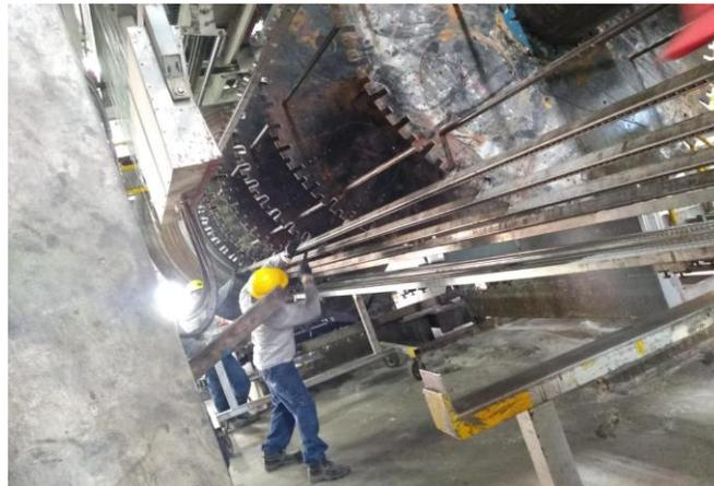
Retirar conjunto de platos: Se retira del eje los platos que fueron usados en la producción anterior, y se deja el eje limpio para colocar los de la producción siguiente.
