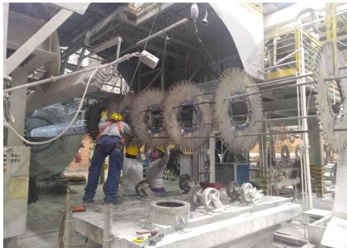
Maquina sin montaje: Así quedaría sin platos la maquina luego de que se bajara el fleje, las vigas y el conjunto de platos.
