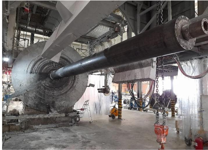
Colocar nuevos discos: Se seleccionan los discos para ser usados en la referencia a fabricar, estos deben estar armados y con sus respectivos bujes para ser colocados inmediatamente en el eje, esta actividad se realiza con 3 personas
