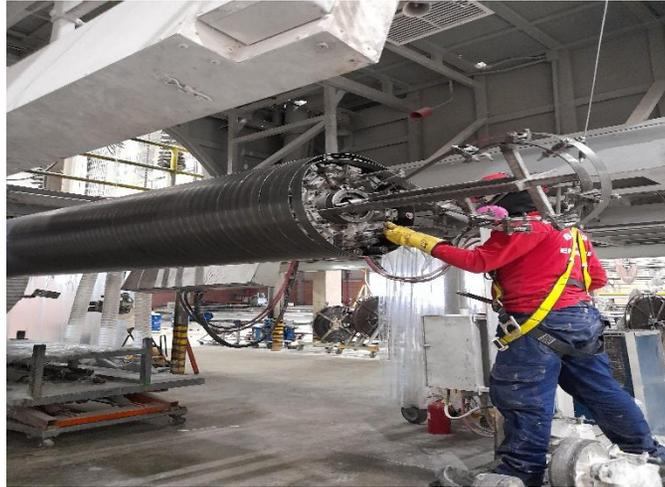
Hacer sin fin: Cuando ya se finaliza de enhebrar el fleje en el mandril, se procede a unir las puntas del fleje para así poder realizar el sin fin mediante un equipo de soldadura.
