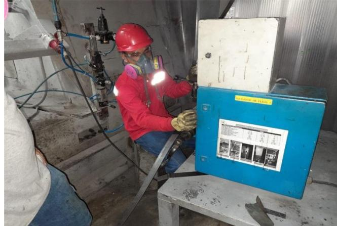
Calibrar arena: cuando ya se está enhebrando el fleje se procede con la calibración de la arena, que consiste en colocar una bandeja especial para recoger la arena que sale de la maquina cuando cae al mandril, por 1 min, este peso se toma y se digita en el PLC para saber con qué dato de Kg de arena se va a arrancar.
