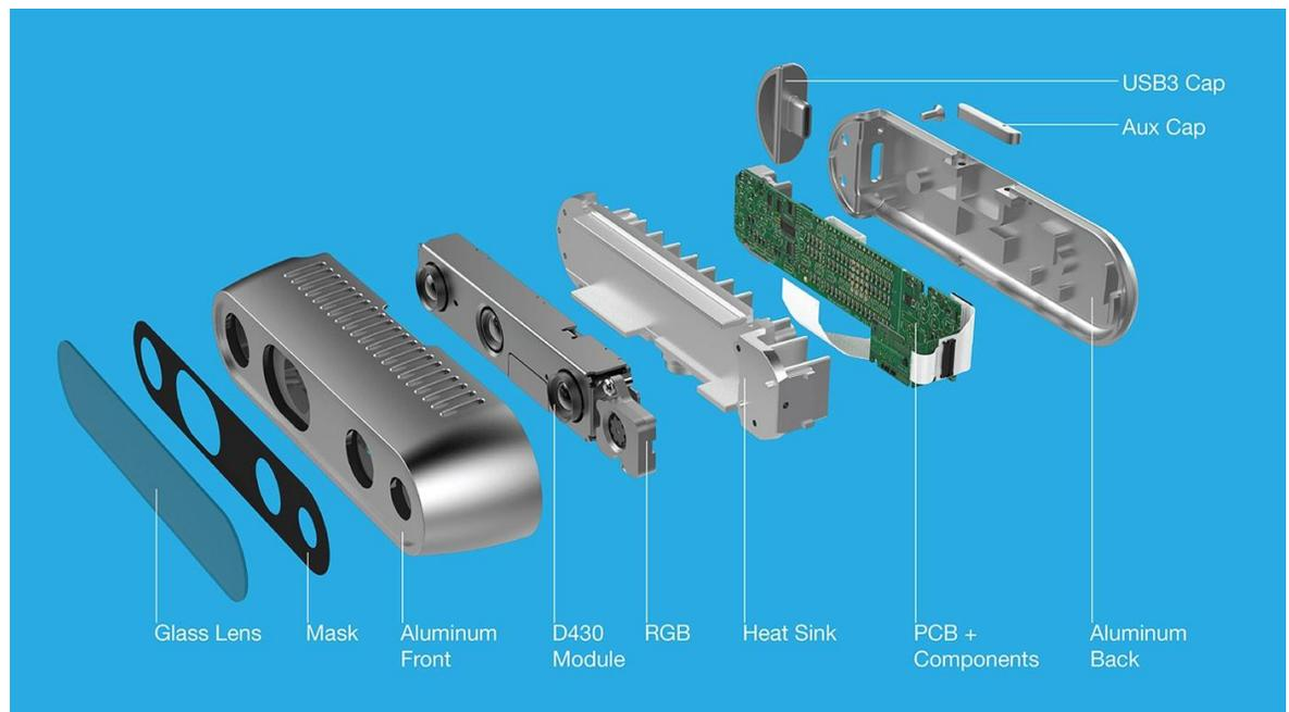
Ilustración 9. Partes de cámara D435
