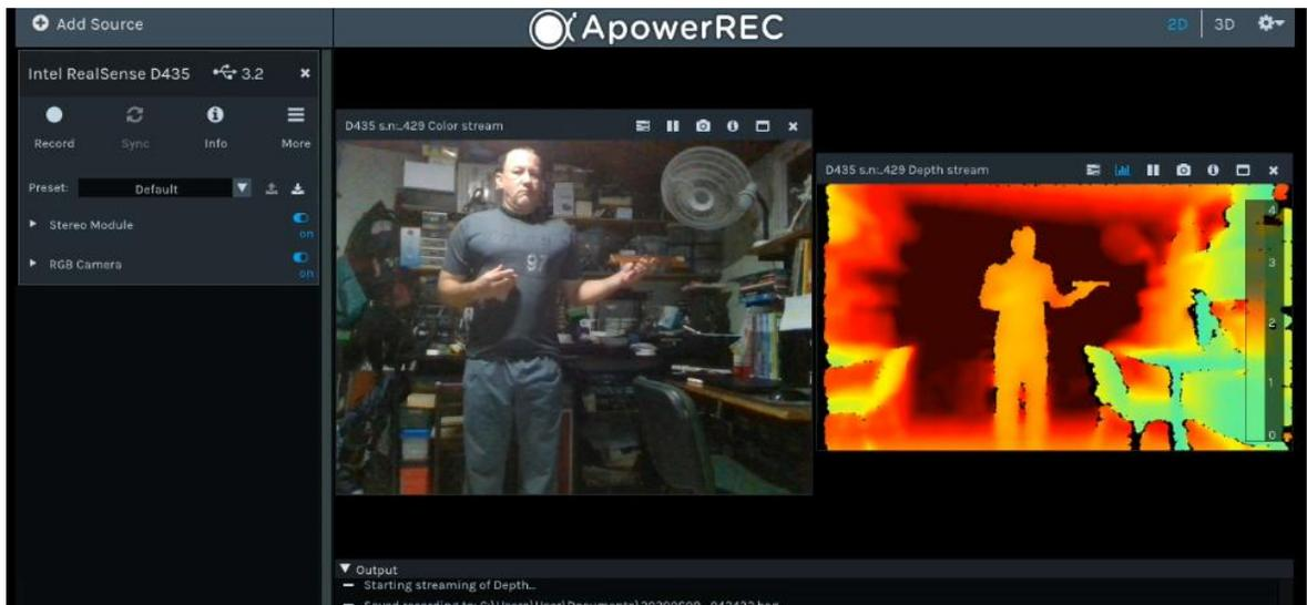
*Ilustración 26. Pruebas de separación entre la silueta y objetos. Objeto en el mismo plano.*
