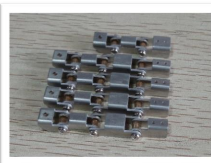
Ilustración 38 Los 5 dedos armados (fuente del manual de la mano robótica)
