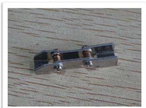
Ilustración 37 primer dedo (fuente del manual de la mano robótica)
