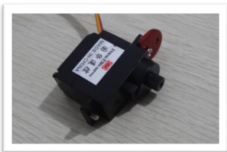
Ilustración 43 Paso 6 servomotores (fuente del manual de la mano robótica)
